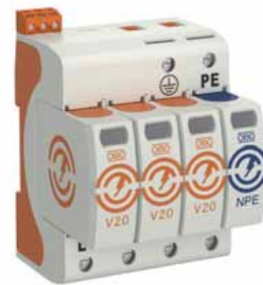
Obrázek 4: Sestava SPD typu 2 pro síť TN-S s mechanickou aretací zasunutého horního dílu a přepínacím kontaktem dálkové signalizace
