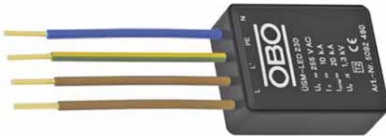
Obrázek 5: Přepětové ochranné zařízení typu 2 pro svítidla LED s možností odpojení chráněného svítidla při poruše
