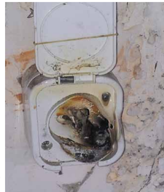
Obr. 3 - spálená zásuvka vlivem sériové poruchy
