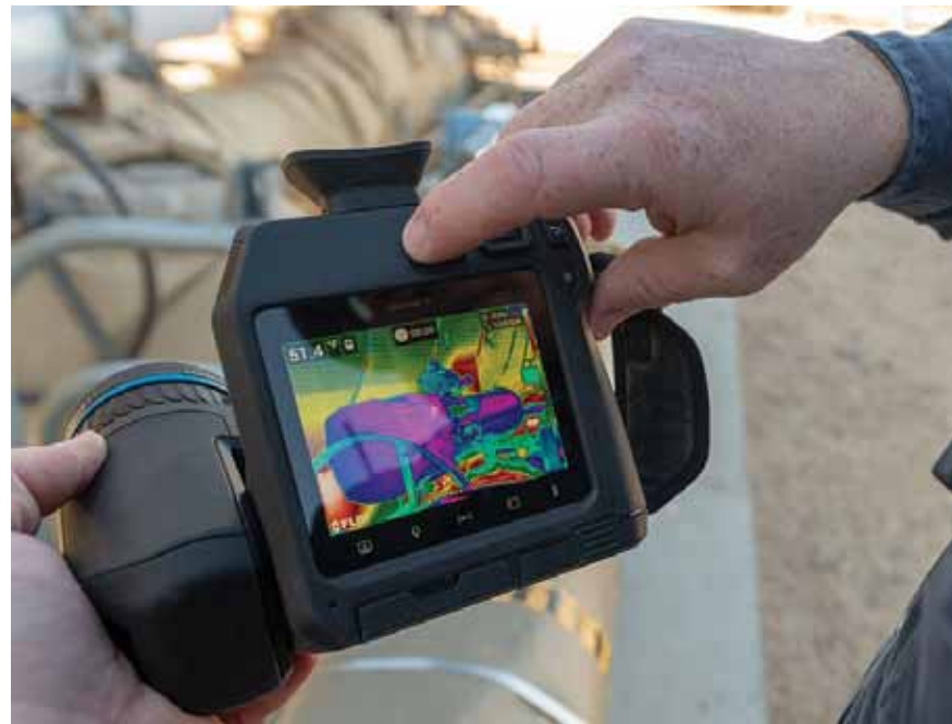
NOVINKA - termokamera FLIR GF77 pro zobrazení úniku plynů
