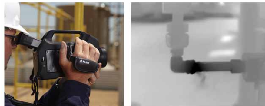
Ukázka zobrazení nalezeného úniku plynu termokamerami FLIR GF
