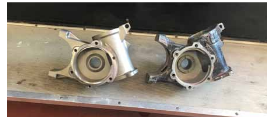
Trvalo to pět dní, než se vytiskla nová skříň řízení. Na pravé straně je vidět původní poškozená část.
