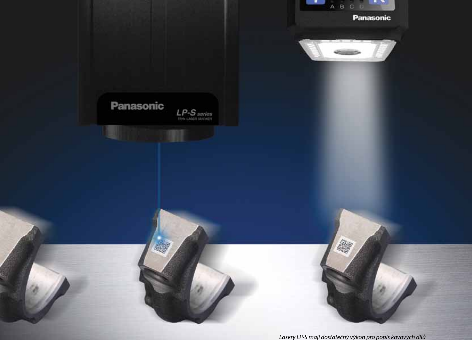
Lasery LP-S mají dostatečný výkon pro popis kovových dílů
