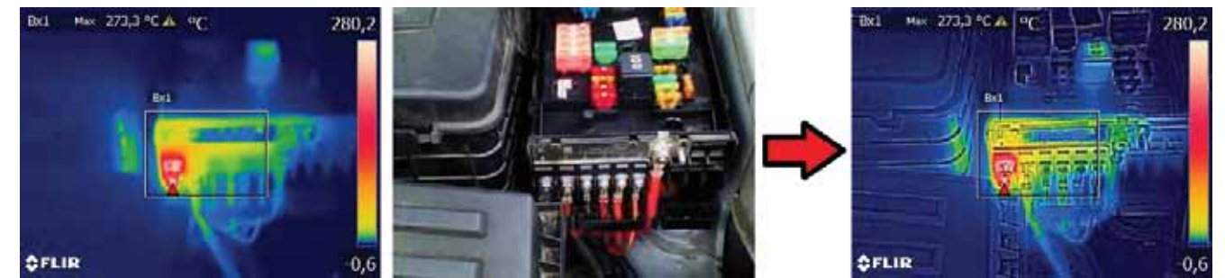
Standardní termogram, foto a výsledný termogram MSX
