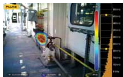
Pohled na plynové potrubí z dálky – orientační určení místa úniku plynu
