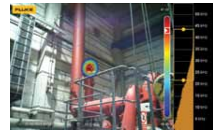
Odhalení špatně uzavřeného ventilu pomocí kamery Fluke ii900
