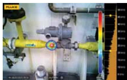
Přesné určení místa úniku plynu – indikace netěsnosti v přírubovém připojení
