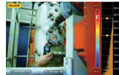
Odhalení místa úniku H 2 potvrzeno i ručním detektorem
