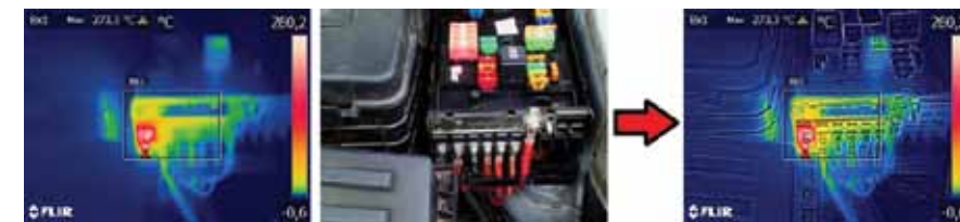
Standardní termogram, foto a výsledný termogram MSX
