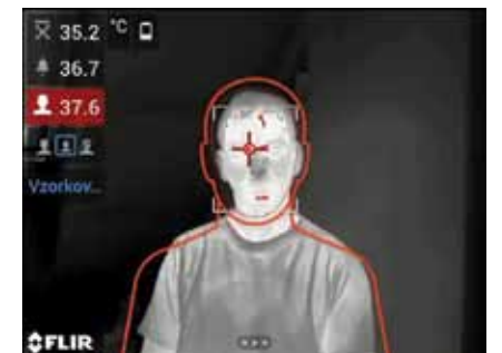
Funkce FLIR se zvýrazněním míst s překročenou teplotou a funkcí siluety
