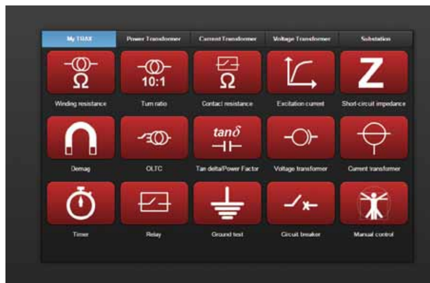
Systém TRAX dokáže nahradit několik samostatných zařízení a zkrátit tak testovací dobu na minimum
