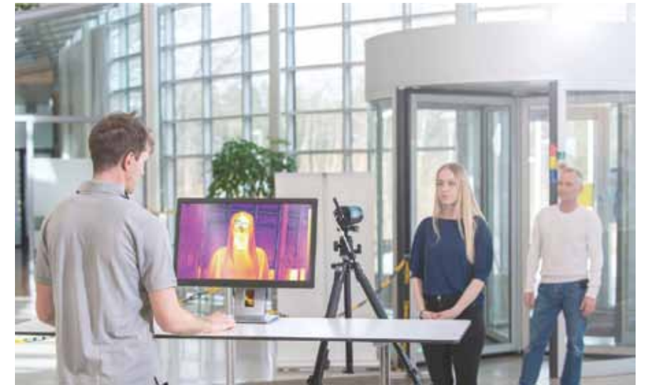
Využití stacionární termokamery FLIR A400 při vstupu do objektu
