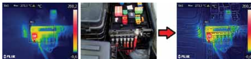
Standardní termogram, foto a výsledný termogram MSX
