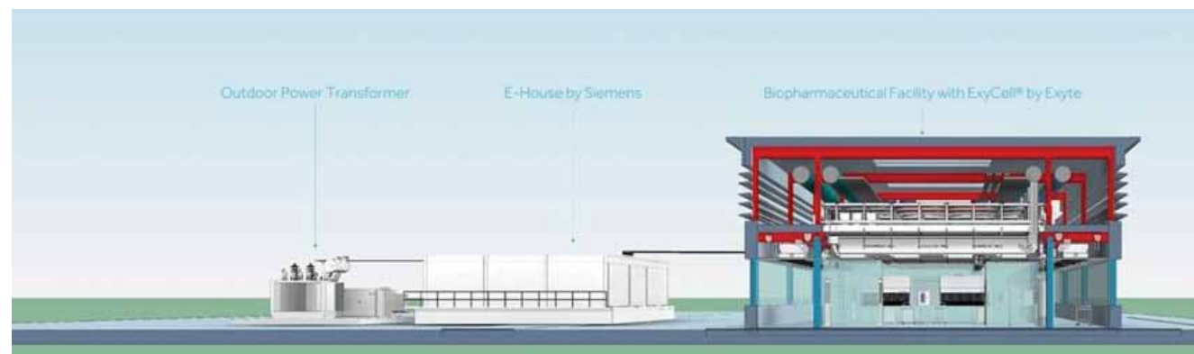
Model biofarmaceutického zařízení složeného z předem nakonfigurovaných modulů ExyCell® a integrovaného napájení společnosti Siemens
