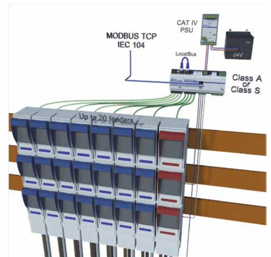
Monitoring vývodů distribuční trafostanice
