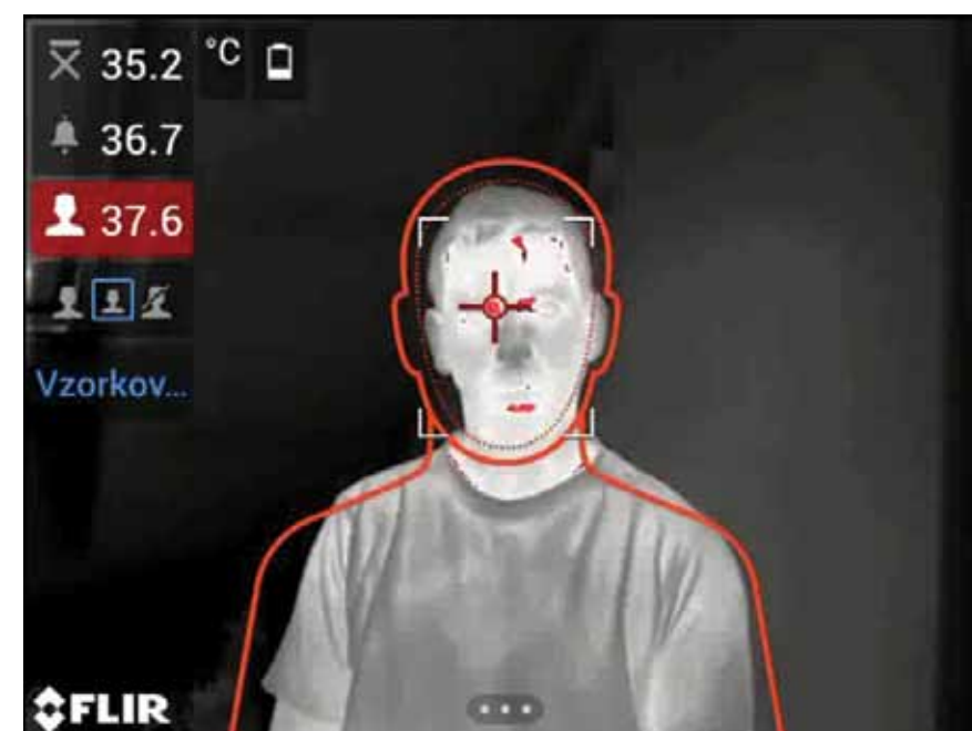
Funkce FLIR se zvýrazněním míst s překročenou teplotou a funkcí siluety
