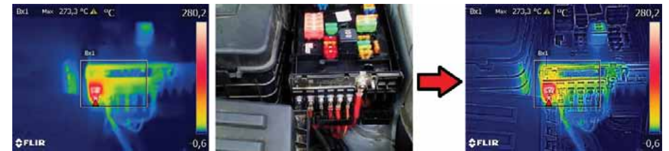
Standardní termogram, foto a výsledný termogram MSX
