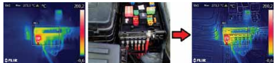
Standardní termogram, foto a výsledný termogram MSX
