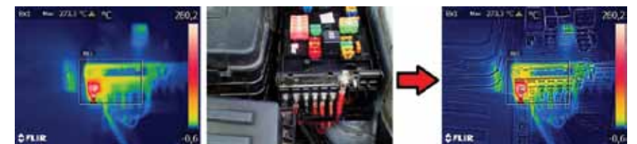
Standardní termogram, foto a výsledný termogram MSX
