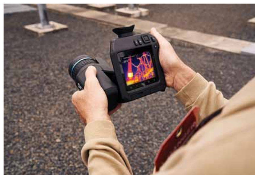
Přenosná termokamera v terénu FLIR T865
