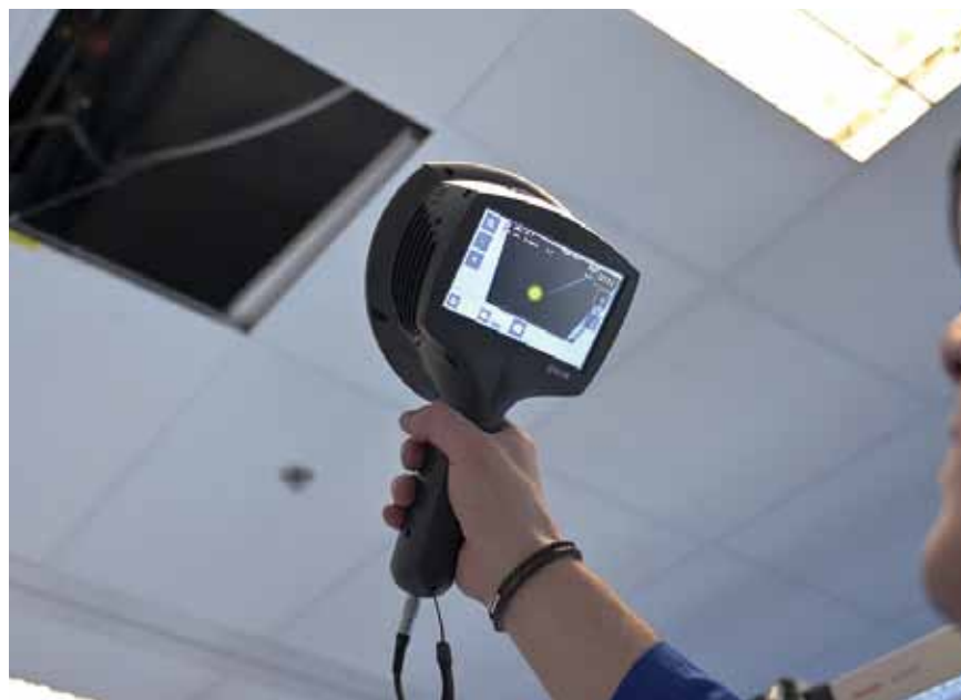
Akustická kamera FLIR Si124 FLIR
