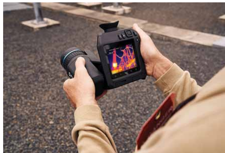
Přenosná termokamera v terénu FLIR T865
